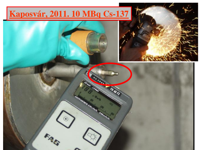
Műszerbe épített cézium sugárforrás
